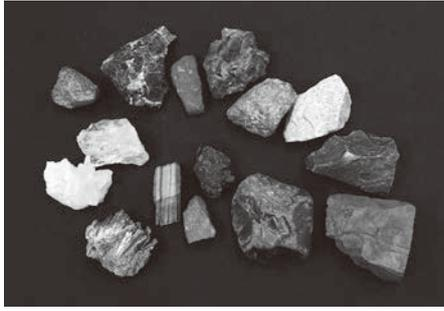
図3. 左上から時計回りで、ラピスラズリ、ソーダライト、アズライト、マラカイト、クリソコーラ、アマゾナイト、グリーンジャスパー、レッドジャスパー、カーネリアン、赤鉄鉱、辰砂、タイガーアイ、石黄、方解石、石英
